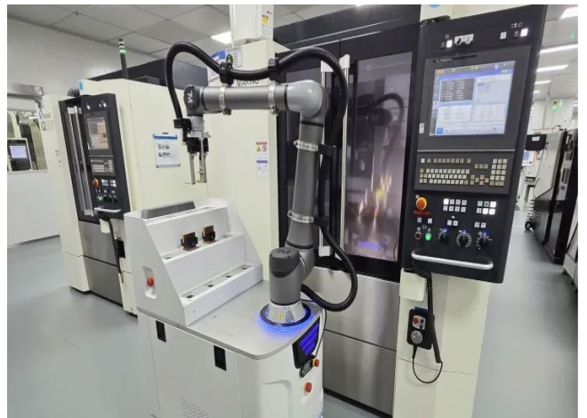
自動搬送ロボット（AMR）：精密機械部品を製造するCNC装置における切削工具の補充
