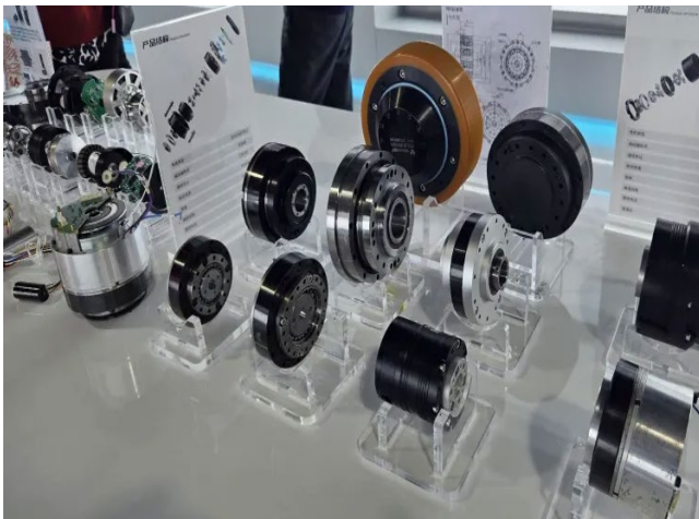
ハーモニック減速機およびブラシレス電動モーターといった主要部品で構成されるアクチュエーター関節
