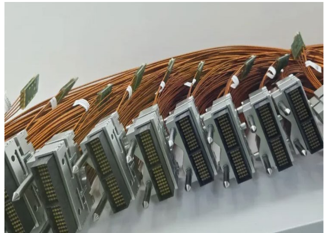
ケーブルカートリッジ組立の最終プロセス
